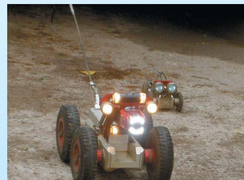
Роботехника Rovver для обследования внутреннего состояния трубы
